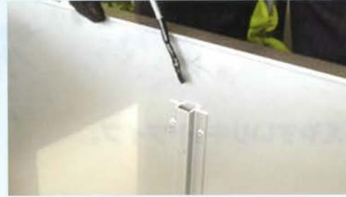
内部の下部に設置されるセンサーは、子豚が噛み切らないようにセンサーカバーに通し保護している
